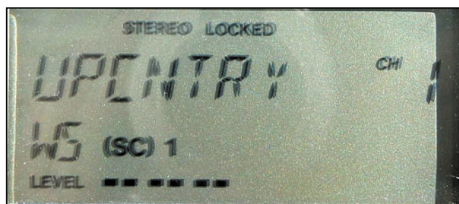
Le nom de la station et le niveau de réception sur le LCD.
