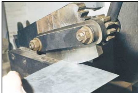
Photo 5 - Découpage de la tôle.
