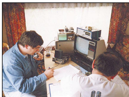
Vue des équipements. De gauche à droite : Tout seul, l'émetteur de télécommande, puis l'alimentation, RX ATV, TRX 2m, enfin écran TV, magnétoscope.
