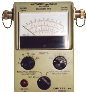
RW 501 Wattmètre- réflectomètre ORITEL
