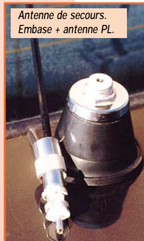
Antenne de secours en place.
