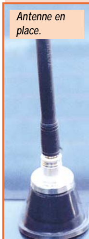
Antenne de secours. Embase + antenne PL.
