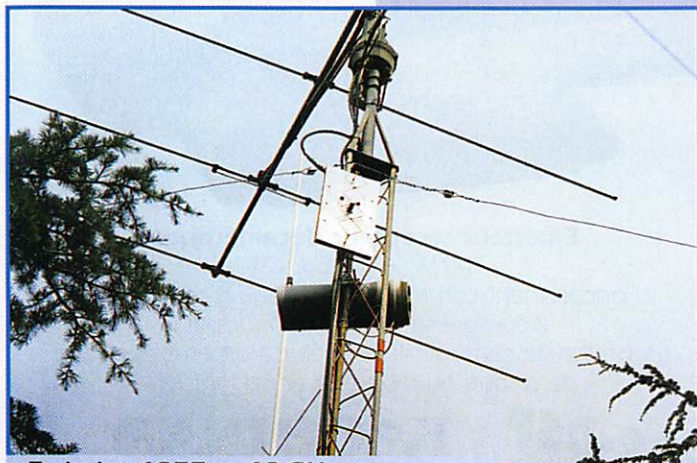
Emission 1255 et 10 GHz dans son enceinte thermostatée.
