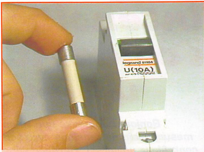
Photo 4 - Disjoncteur et fusible.
