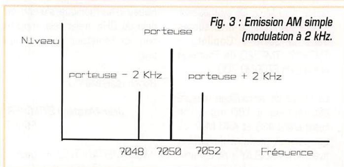
Fig. 3 : Emission AM simple (modulation à 2 kHz).
