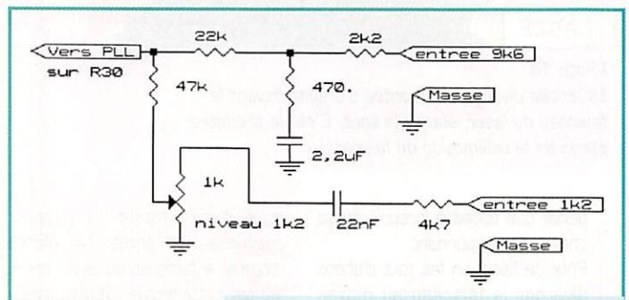
Figure 3 : Circuit externe pour le packet.
