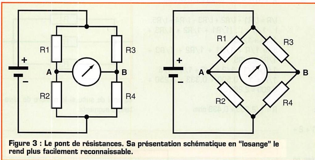
Figure 3 : Le pont de résistances. Sa présentation schématique en "losange" le rend plus facilement reconnaissable.
