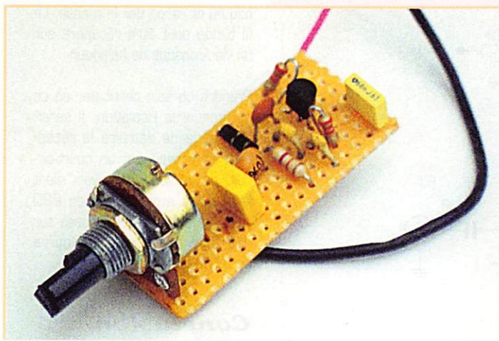
**Le BFO monté sur du Veroboard. Le condensateur variable a été remplacé par un fixe de 68 pF.**
