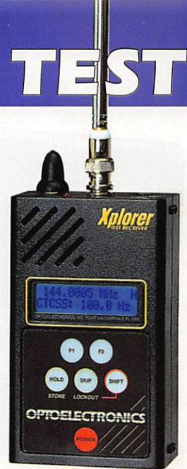
Capteur d'émissions FM proches. **XPLORER**
