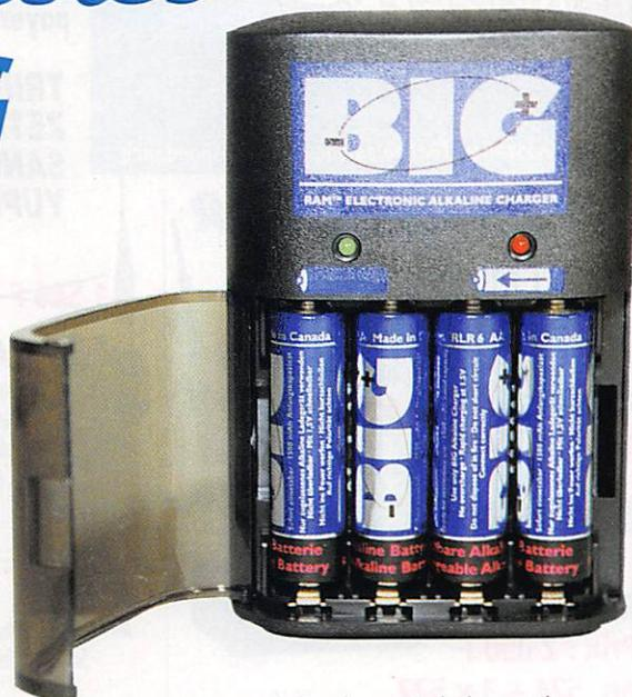
**C'est la révolution dans le monde des piles. Exit les accus rechargeables cadmium-nickel, et longue vie aux « BIG » qui, par leur tension de 1,5 V, sont comparables aux piles alcalines avec l'avantage incontestable de pouvoir être rechargées.**
