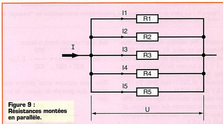
Figure 9 : Résistances montées en parallèle.
