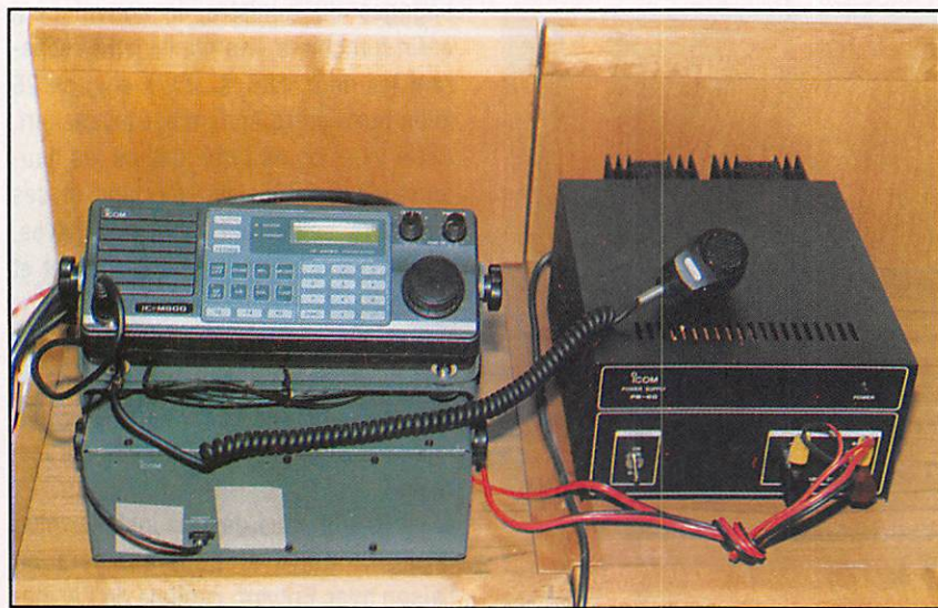
Erevan, 26/03/92. Station H.F. Icom IC-M800 à face avant déportée, alimentation Icom PS60.
