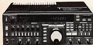
**YAESU - FT 757GX//.** Transceiver décimétrique nouvelle technologie, couverture générale de 500 kHz à 30 MHz en réception, émission bandes amateurs. Tous modes + entrée AFSK et Packet. 100 W. Alimentation 13,8 Vdc. Dimensions 238 x 93 x 238 mm, poids 4,5 kg. Option interface de télécommande pour Apple II ou RS 232C et cartouche MSX.
