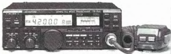
Emetteur-récepteur TR 751 E 144 à 146 MHz / tous modes / 25 W et 5 W HF / commutable en tous modes.
