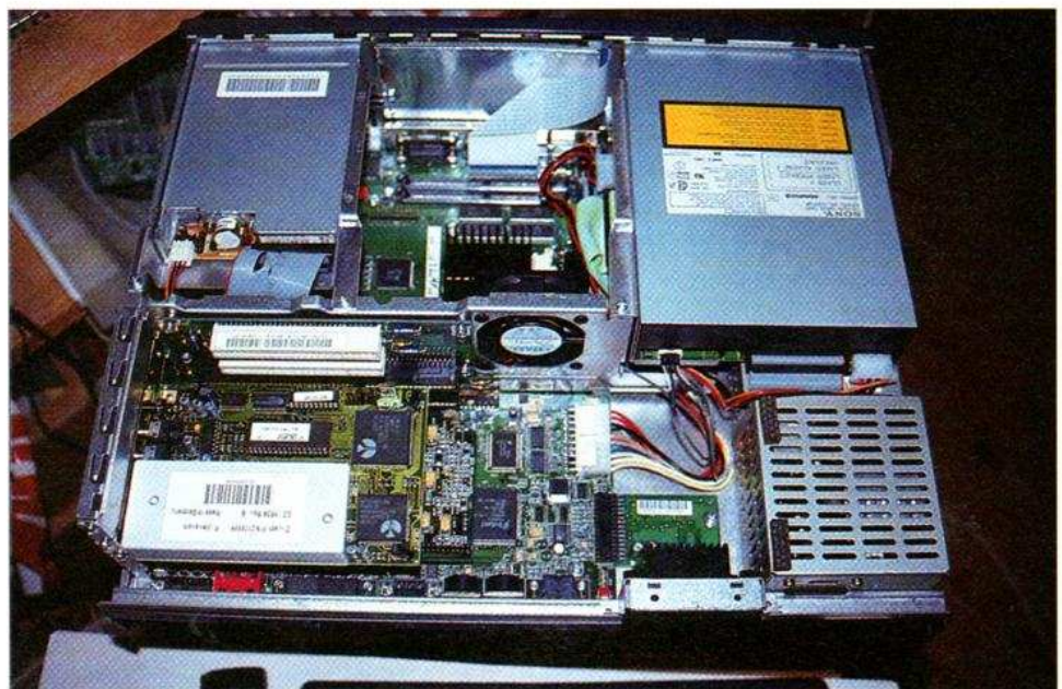
Vue plongeante sur un véritable objet du futur : en haut à gauche, le lecteur de disquette, et à droite (avec étiquette jaune), le lecteur de CD Rom. Derrière le ventilateur, le Pentium, microprocesseur cadencé à 75 MHz. En bas à gauche, les cartes (son, vidéo) et les emplacements pour cartes additionnelles. A droite, l'alimentation, particulièrement compacte, pour un ordinateur.
