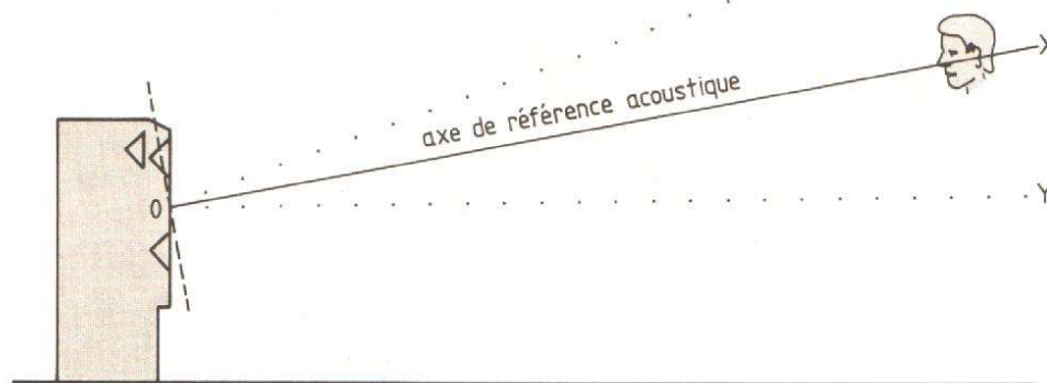
Fig. 16. - La cellule de retard, passe-tout, de la figure 15, recule électriquement le haut-parleur médium du haut, par rapport à son homologue inférieur. L'axe d'écoute privilégié se relève selon OX ( XOY = 10^\circ ), de manière à atteindre les oreilles d'un auditeur normalement assis à 2,5 m. La fenêtre verticale d'écoute est définie par l'angle YOZ = 20^\circ .
