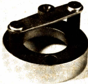
Fig. 6. - La crapaudine surélevée par deux colonnettes est solidaire d'une pièce cylindrique ajourée que traversera la jupe d'amortissement ; tout en constituant un couvercle à la partie supérieure, en plexiglass, de l'embase cylindrique. Il y a ainsi largement place aux fils de connexion au dessous de la crapaudine (cette solution est très ingénieuse).
