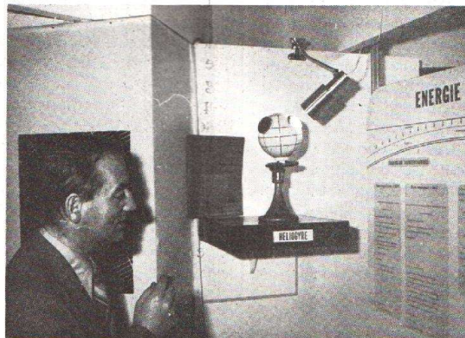
Fig. 5. - L'héliogyre, une application de l'énergie solaire, il s'agit d'un moteur sans collecteur, la commutation est assurée par la rotation des cellules, le courant dans les bobinages du moteur est faible lorsque la cellule n'est pas éclairée.
