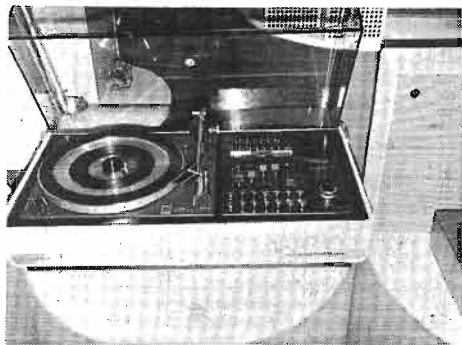
Chaîne intégrée Siemens à accord par varicap en AM et en FM.
