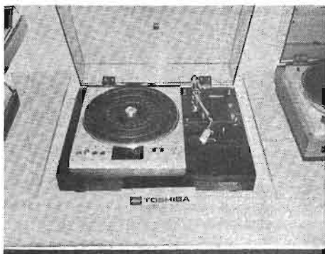
Platine Toshiba SR50 à entraînement direct.
