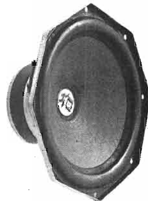
HP graves asservi de National Feedback système Philips. On remarque au centre le circuit imprimé recevant l'accéléromètre et le transistor fet.
