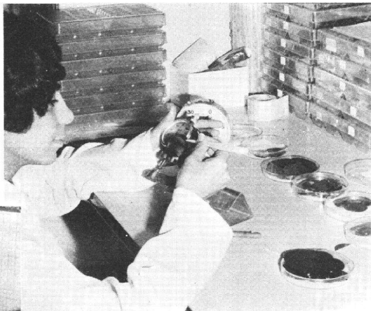
Leur épaisseur est soigneusement mesurée au micromètre.
