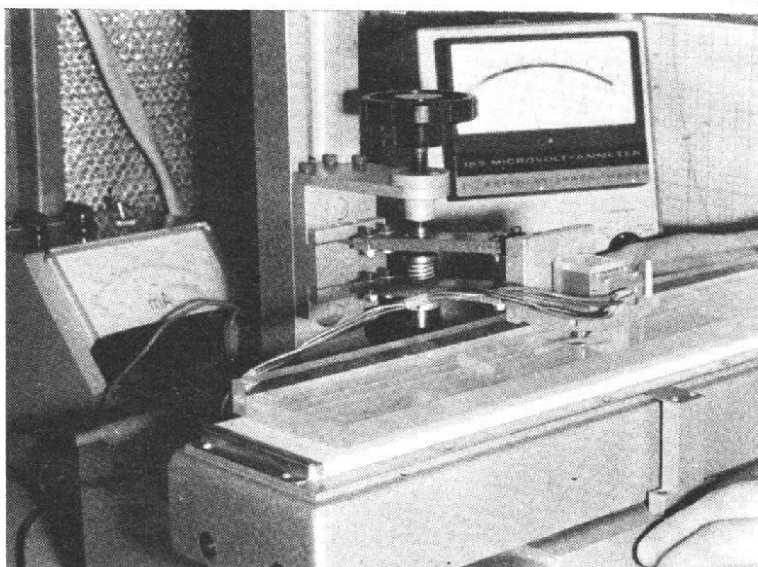
L'état de surface est finalement contrôlé par une mesure de résistivité.
