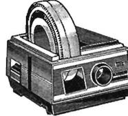
Projecteur automatique - Marche avant, arrière et mise au point télécommandées : minuterie incorporée commandant le passage des vues toutes les 8, 15 et 30 secondes environ. Lampe 24 volts 150 Watts iode, soufflerie de refroidissement. Paniers de 30, 36 ou
