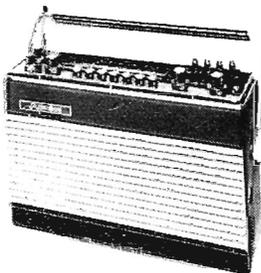
Récepteur FM PO-GO-2 OC. 12 transistors + 14 diodes (Silicium). Puissance 2 W (4 W sur accu).
