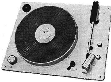
Alimentation : 220 V, 50 c/s, 15 W. Plateau : diamètre 25 cm. Poids : 1,3 kg. Rapport S/B : 40 dB. Pleurage : 0,3 %. 4 vitesses. Réglage magnétique des vitesses : 15 %. Courbe de réponse : 40-15 000 c/s. Tension de sortie : 300 mV, 50 mm/sec. Compliance : 2,0 x 10<sup>-6</sup> cm/dyne. Séparation des voies : 20 dB à 1 000 c/s. Equilibre des voies ± 2 dB. Dim. : 400 x 300 mm. PRIX (T.T.C.) ..... **179,00**
