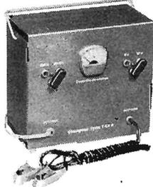
Modèle T43 (ci-contre) - Entrée 110/220 V - Sorties 6 Volts / 5 Amp. et 12 Volts / 3 Amp., protection par fusibles, secteur et B.T., ampèremètre de contrôle, boîtier métal. portable 20 x 21 x 12 cm.
