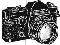
Reflex japonais, à cellule derrière optique (2 cell. dans le prisme). Obturateur 1 sec. ou 1/1000 pose B, retardement, 2 prises flash. Objectif 1,4 interchangeable, diam. standard 42 mm de très haute définition. Mise au point sur micro-prisme.
