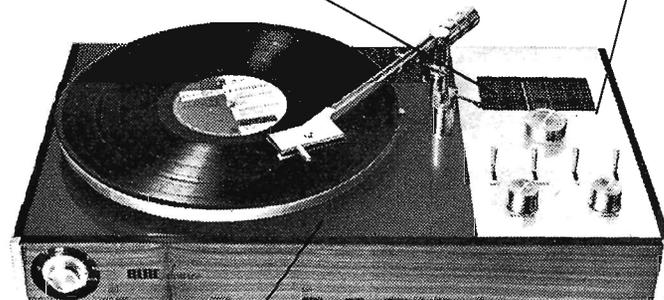
Si vous frappez de la main sur le dessus du "Bloc-Source" aucun choc ne se transmet au bras ou au plateau. Ils sont rigoureusement isolés grâce à une contre platine suspendue à l'intérieur de l'appareil.
