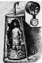
Cet appareil n'est pas une cabine de douche, mais un calorimètre à haute fréquence de d'Arsonval. Le sujet se tient debout dans cette énorme bobine parcourue par les courants de haute fréquence, ce qui permet de mesurer l'effet radiatifateur de ces courants.
