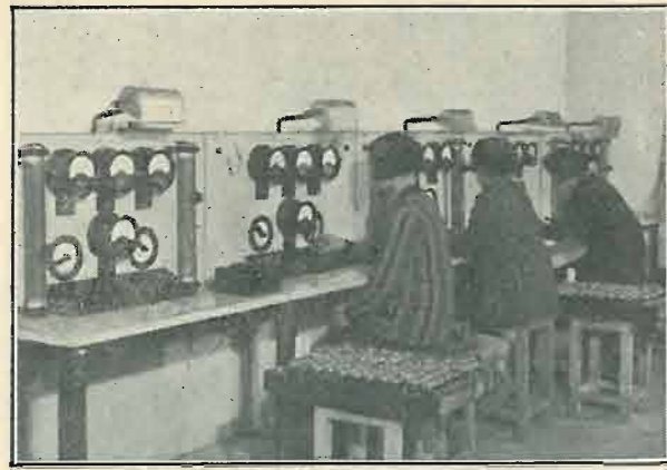
Fig. 11. — Il controllo delle caratteristiche delle valvole.
