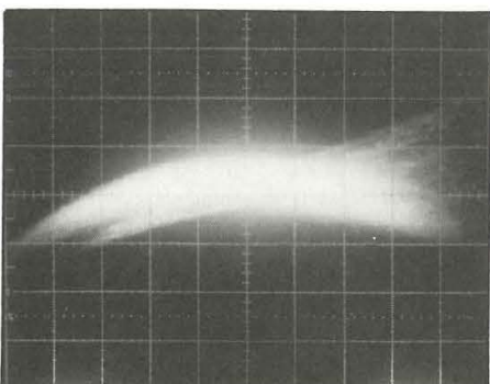
Fig. 6 : La distorsion absolue pour un signal musical, visualisée en figures de Lissajous (à gauche avec l'atténuateur, à droite avec le filtre). Pour les figures 4 à 6, les échelles sont les mêmes.
