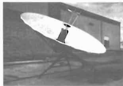
Fig. 1 - Un paraboloide da 3 m di diametro in cortile. L'illuminatore tipo Cassegrain è per le frequenze di 2 ÷ 3 GHz.
