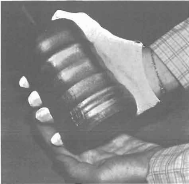
Fig. 1 - Un lingotto di GaAs pronto per la lavorazione in laboratori altamente specializzati. Da esso attraverso il tiraggio del monocristallo, il taglio in sottilissime fettine, il drogaggio col procedimento epitassiale o con la iniezione di ioni di materiale drogante; nasce il transistor, il FET il diodo oppure il monodo quale «l'elemento Gunn».
