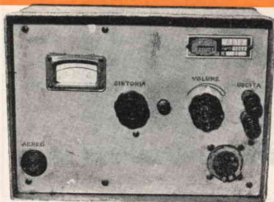
2) Radiogoniometro Ricevitore prof. Ottimo. Monta nove valvole. Tre gamme, adatto anche per doppia conversione. Senza valvole L. 10.000
