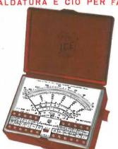
Record di ampiezza del quadrante e minimo ingombro! (mm. 128x95x32) **Record** di precisione e stabilità di taratura! (1% in C.C. - 2% in C.A.!) Record di semplicità, facilità di impiego e rapidità di lettura! Record di robustezza, compattezza e leggerezza! (300 grammi) Record di accessori supplementari e complementari! (vedi sotto) **Record** di protezioni, prestazioni e numero di portate!
