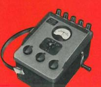
Fig. 9 - Misuratore di terra ad azzeramento
