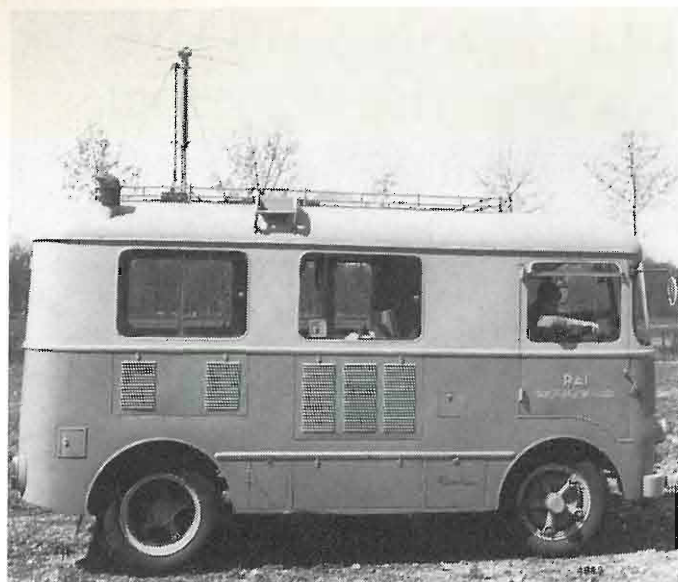
Fig. 1. — Automezzo attrezzato per le misure del campo elettromagnetico.
