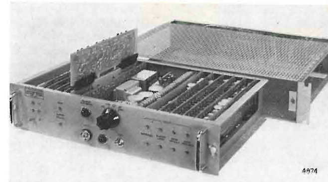
Fig. 3. — Generatore di impulsi per norma a 625 righe per TV monocroma realizzato a transistori (1961).
