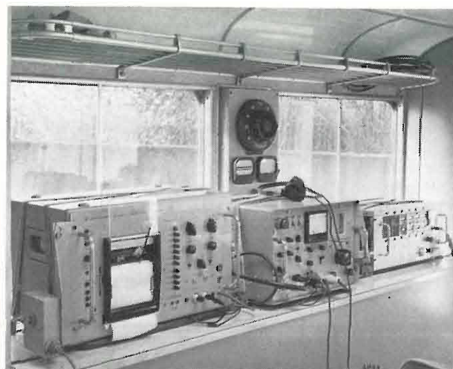
Fig. 2. — Apparecchiature installate all'interno dell'automezzo per le misure del campo elettromagnetico (v. anche copertina).
