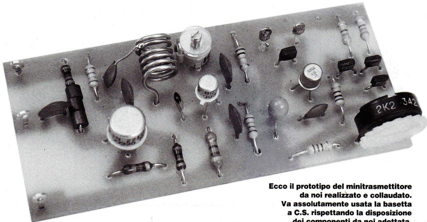
**Ecco il prototipo del minitrasmittitore da noi realizzato e collaudato. Va assolutamente usata la basetta a C.S. rispettando la disposizione dei componenti da noi adottata.**
