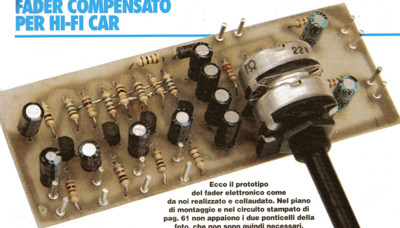
**Ecco il prototipo del fader elettronico come da noi realizzato e collaudato. Nel piano di montaggio e nel circuito stampato di pag. 61 non appaiono i due ponticelli della foto, che non sono quindi necessari.**
