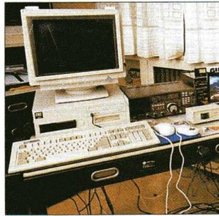
**Con un ricevitore per onde corte**, unito ad un normale PC casalingo, possiamo ricevere e decodificare i messaggi delle agenzie di stampa, le cartine meteorologiche e altro.
