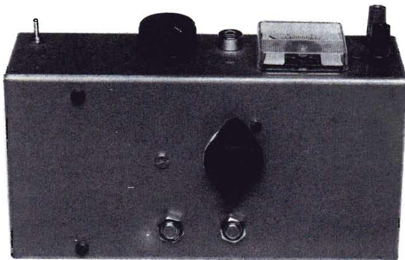
Fig. 5 - L'integrato IC1 appare fissato nella parte di sotto del contenitore metallico e racchiuso con una corrispondente capsula di materiale isolante. Tra la superficie metallica del contenitore ed il componente, si deve interporre un foglietto di mica cosparso di grasso al silicone.
