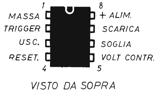
Fig. 1 - Versione mini-dip dell'integrato NE555 adottato nel circuito elettronico dell'anemometro. L'interpretazione delle diverse voci, riportate in corrispondenza dei piedini del componente, è fatta con abbondanza di particolari nel corso dell'articolo.
