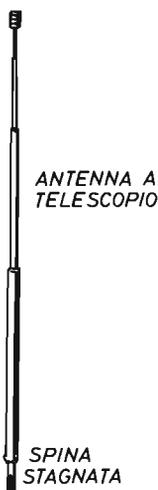
**Fig. 3 - L'uso del misuratore di campo può essere fatto in modi diversi. Quello più semplice consiste nel servirsi di un'antenna a stilo da collegarsi direttamente con l'apposita presa ricavata nel circuito d'entrata dello strumento.**
