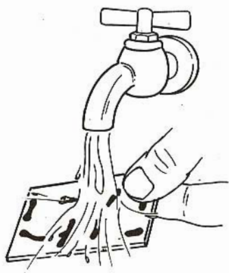
Fig. 8 - La piastrina deve essere tolta dal bagno servendosi di comuni pinze per stendere la biancheria. Subito dopo deve essere posta sotto l'acqua corrente in modo che ogni rimanente traccia di acido scompaia. Occorre comunque evitare sempre di toccare la piastrina con le mani e fare in modo che l'acido non venga mai a contatto con la pelle o gli indumenti. Se ciò dovesse accadere bisogna subito lavare accuratamente le parti intaccate dall'acido con acqua e sapone. L'acido contenuto nella bacinella verrà riposto in una bottiglia, perché esso servirà per la composizione di altri circuiti stampati.
