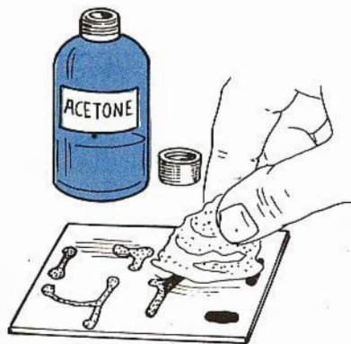
Fig. 9 - Dopo aver bene lavato la piastrina e dopo averla ben asciugata con uno straccetto, occorre eliminare la vernice all'acetone o smalto per unghie, strofinando la superficie con un batuffolo di cotone imbevuto di acetone. Si tenga presente che se le piste di rame risultano leggermente ossidate, lo stagno della saldatura non attacca. Meglio dunque, prima di iniziare il montaggio del circuito, pulire con pomice, paglietta d'acciaio o carta vetrata molto sottile le piste di rame. Soltanto ora, servendosi di un trapano a mano con punta sottile, si possono praticare i fori in cui verranno inseriti i terminali dei componenti.
