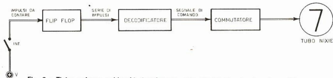
Fig. 2 - Tipico schema a blocchi riprodotto una catena di visualizzazione. L'interruttore fornisce un impulso all'unità di conteggio (flip-flop); le uscite di questo vengono inviate al decodificatore, che fornisce tensione ad una sola tra le sue dieci uscite, più precisamente a quella equivalente al numero di impulsi contati sino a quel momento. Le dieci uscite vengono inviate ad uno stadio pilota di potenza (commutatore) che risulta direttamente allacciato con la valvola nixie.
