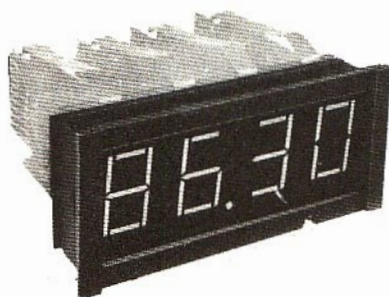
Fig. 14 - Strumenti di misura e orologi possono essere costruiti sfruttando il sistema di rappresentazione numerica, con diodi fotoemettitori; a sette segmenti.
