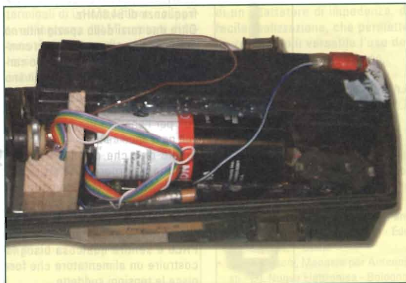
foto 1: vista interna: si notano i due faston, in basso a destra il trasformatore ed il pezzo di legno sagomato che funge da isolatore
