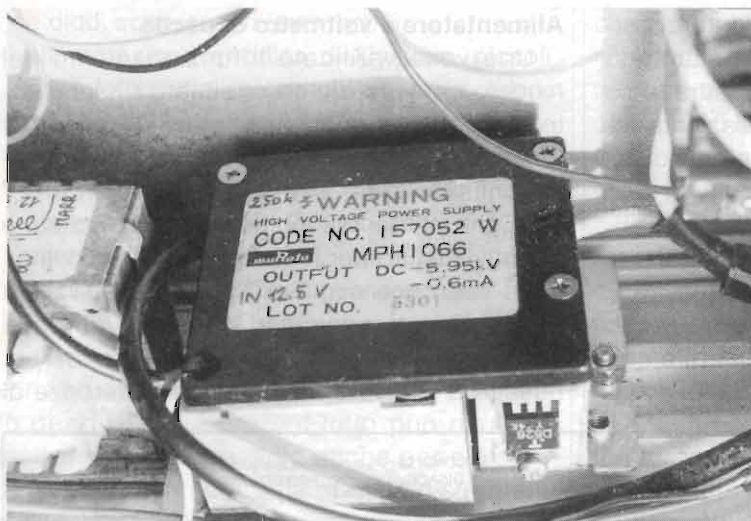
Foto 2 - Particolare della realizzazione con in evidenza l'altro modulo convertitore, questa volta a telaio chiuso (MPH1066)
