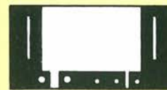
Figura 5. Il circuito stampato scala 1:1 del contenitore per pilette potrebbe essere simile a questo. I due tagli dove inserire le piastrine possono essere, per comodità, estesi fino al lato inferiore dello stampato.
