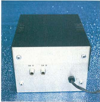
Foto 3. Sul pannello posteriore, oltre al cavo di alimentazione, sono presenti le entrate per gli assi X e Y.
