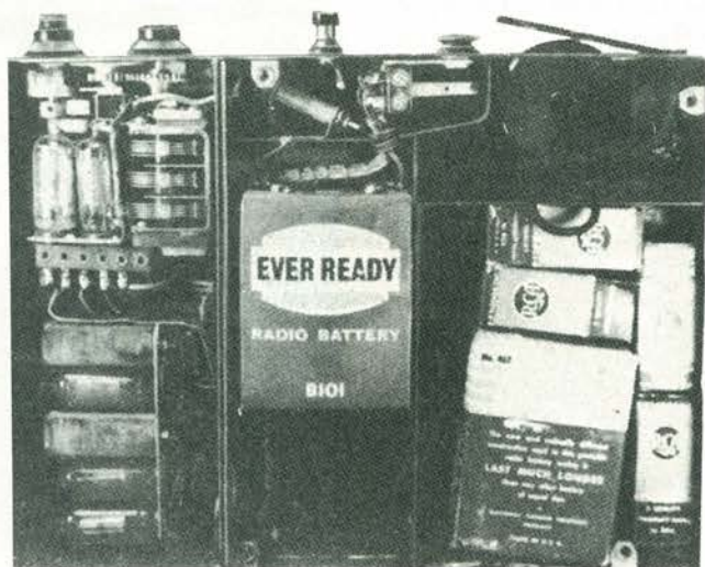
Figura 5. Ricevitore a valigetta delle Special Communications, che impiegava valvole ad 1,5 V e batterie ad elementi stratificati: epoca 1943-44 circa.
