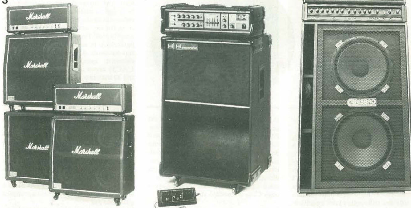
Foto 3. Un terzetto di amplificatori di altissima potenza. Il Marshall è a valvole, mentre sia il Carlsbro che l'H/H sono allo stato solido.
