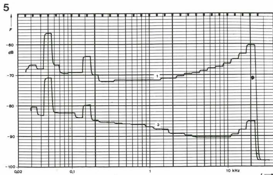
Figura 5. Lo spettro di rumore caratteristico di una musicassetta senza il compander (1) e con l'High Com (2).
