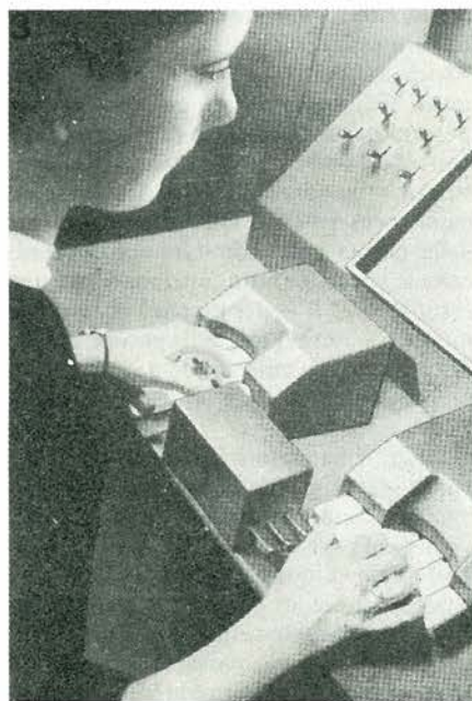
Figura 3. La tastiera del voder (voice operation demonstrator). Si controllano manualmente una serie di filtri del formante, e l'operatore deve essere molto abile per dare origine a suoni coerenti.
