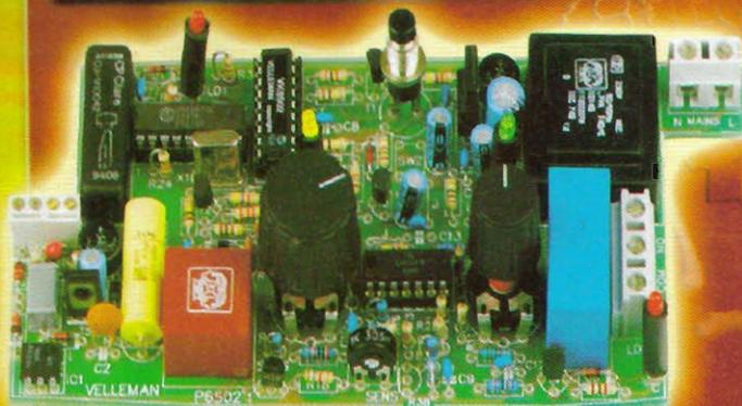
Ce thermostat se caractérise par la possibilité de sélectionner la température de jour ou de nuit via une ligne téléphonique ordinaire. La commande à distance étant actionnée par les touches du téléphone, vous devez disposer d'un téléphone de type DTMF. Le réglage du thermostat est indiqué à l'utilisateur sous forme de signaux sonores. L'activation est protégée par un code à déterminer soi-même, que l'on compose simplement sur le téléphone.
