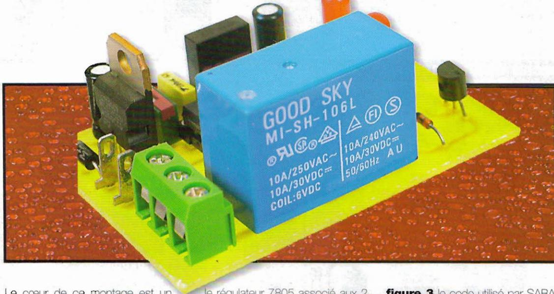
Comme l'explique ce long titre, le montage décrit maintenant est un récepteur infrarouge qui peut être commandé par toute télécommande infrarouge. À l'issue d'un apprentissage de la trame infrarouge émise lors de l'appui sur l'une des touches de votre zapette, le récepteur est capable de reconnaître cette trame. Un relais est alors alternativement ouvert ou fermé lors de toute nouvelle action sur cette touche.
