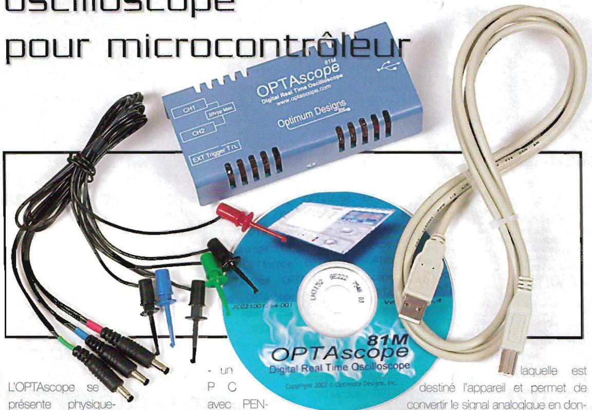
La société OPTIMUM DESIGNS commercialise un nouveau produit, l'OPTAscope 81M spécifiquement conçu pour une utilisation avec un microcontrôleur, tel Le BASIC STAMP. Etant donnée la bande passante limitée à 200 kHz, il sera plus particulièrement réservé aux applications audio.
