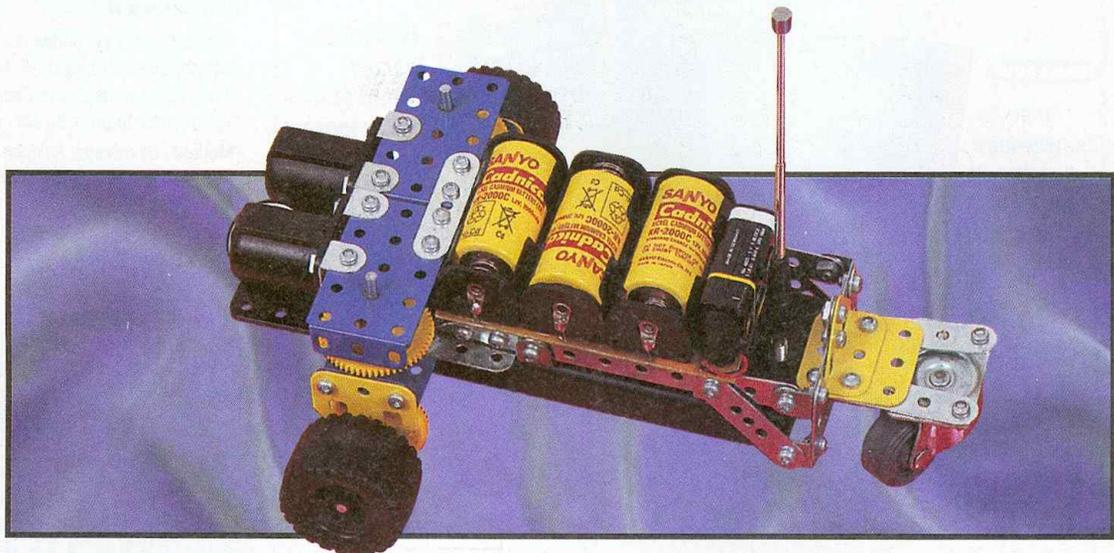
Faire évoluer à distance un objet, sans lien matériel avec l'émetteur en donnant ainsi la vie aux montages, c'est toute la magie de la radio-commande. Dans l'exemple présenté dans cet article, nous avons opté pour une radio-commande à deux canaux simultanés à partir de modules MIPOT pré-réglés, pour simplifier la tâche de nos lecteurs.
