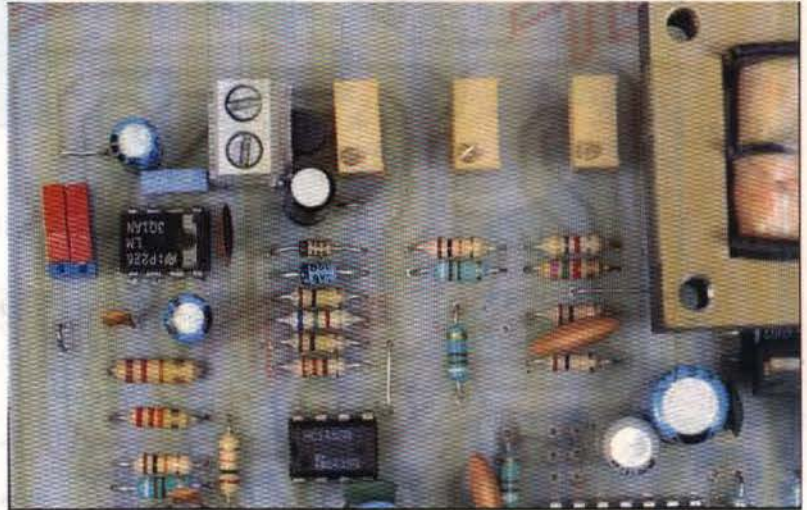
Photo 2. - Le bornier d'entrée du thermocouple.
