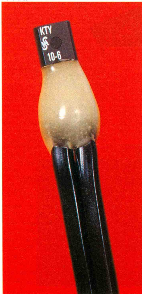
Photo 5. - La sonde étanchéifiée dans de l'araldite.
