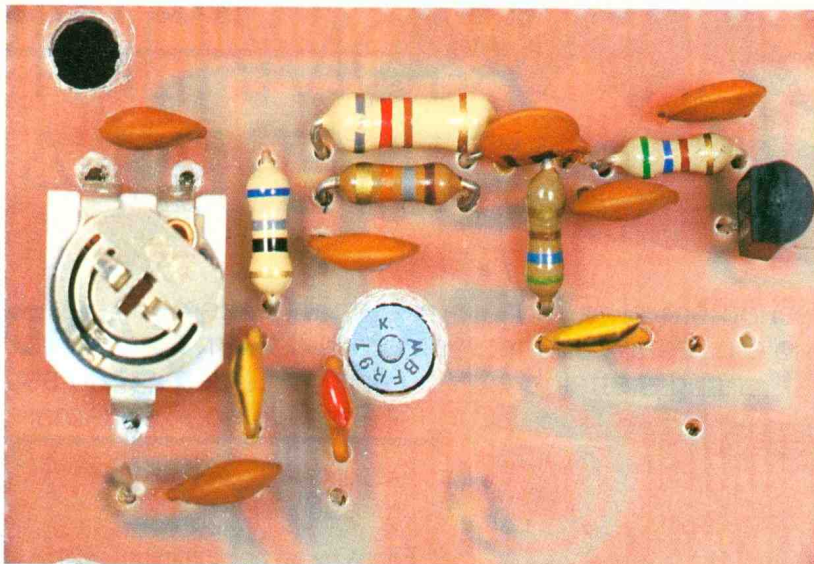
Photo 3. – Vue de l'ajustable R7 et du transistor soudé coté cuivre, se logeant dans un trou de 5 mm.
