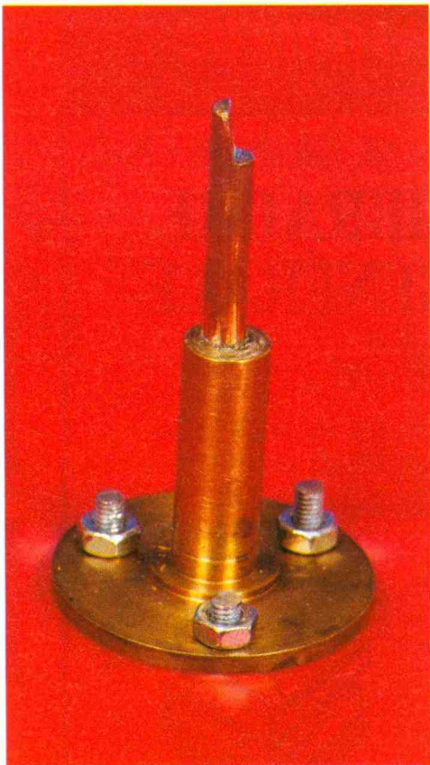
Photo 6. – Détail de l'axe d'entraînement du plateau.
