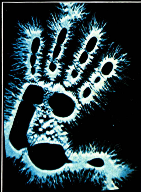
Image électrographique (effet pelliculaire) avec une impulsion positive de 30 kV.
