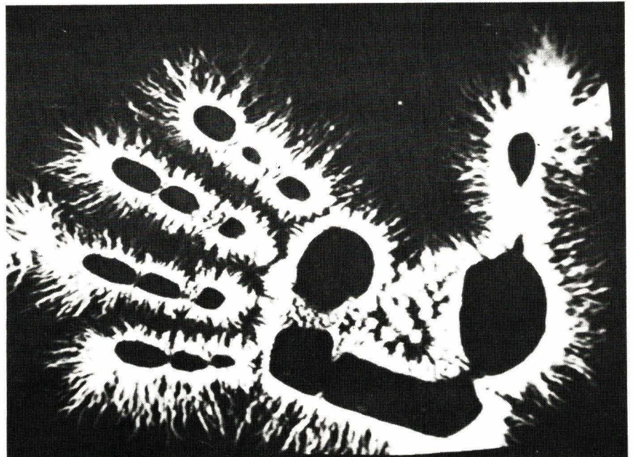
Image électrographique (effet pelliculaire) avec une impulsion positive de 30 kV.
