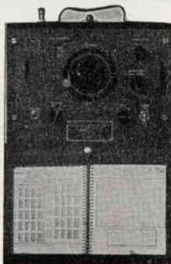
Frequenzimetro BC 221 - Banda da 125 a 20.000 KHz. Completo di libretto di taratura originale, valvole, cristallo di quarzo. Viene venduto al prezzo di L. 20.000 completo e funzionante.
