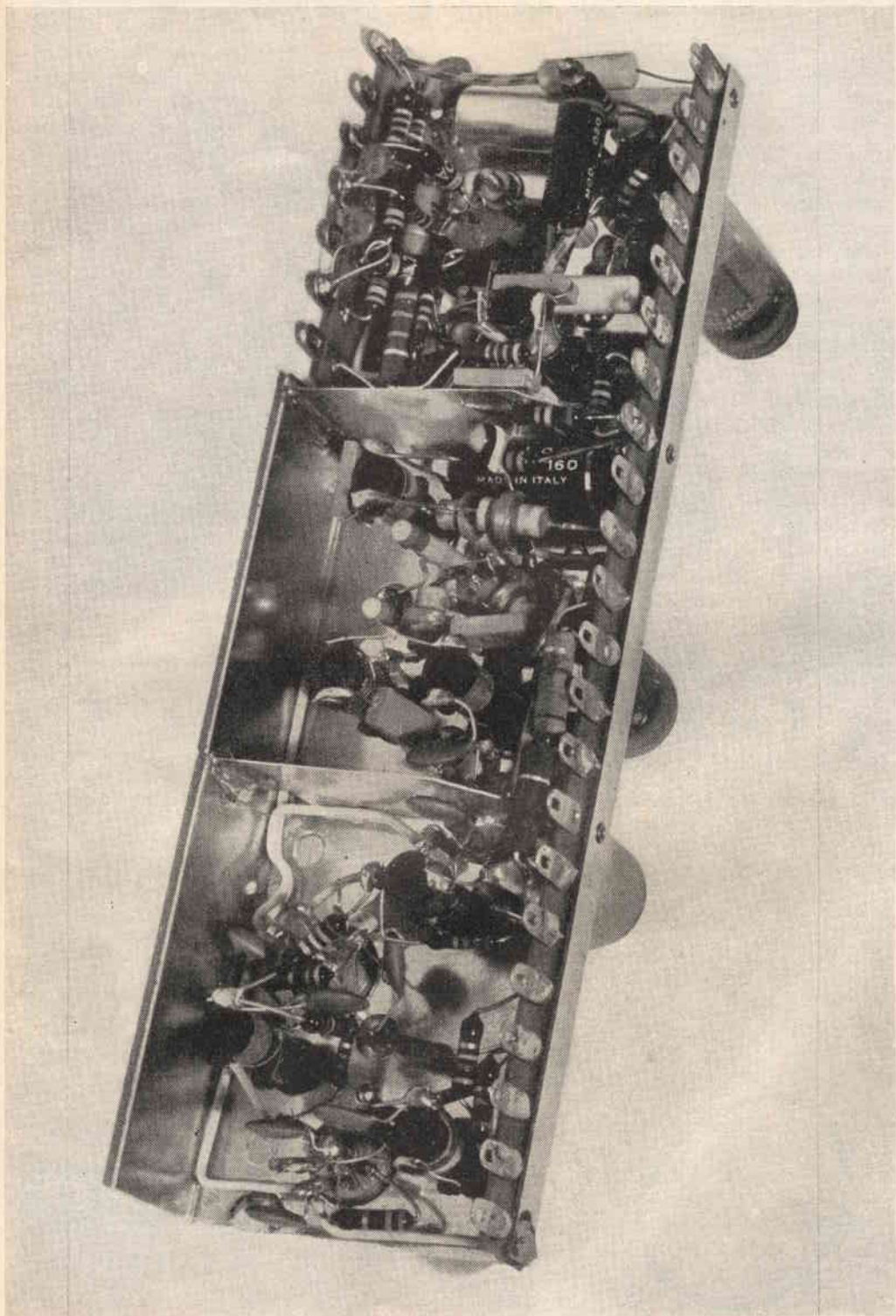
Vista dello chassis M 386 dal lato dei collegamenti.
