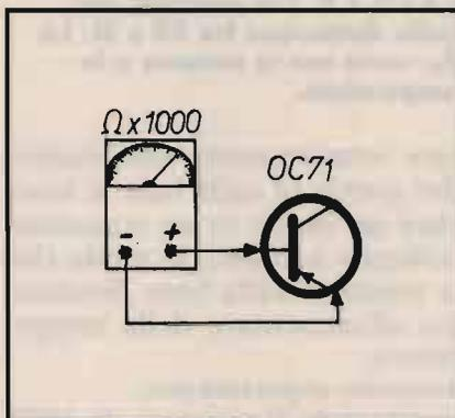
① La resistenza inversa di una giunzione al germanio è nettamente minore, rispetto al silicio. Anche la resistenza diretta è minore. **NON USARE** la portata  $\Omega \times 1$  (passa troppa corrente).
