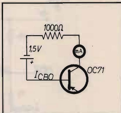
② La corrente inversa in un transistor al germanio è qualche  $\mu\text{A}$ , ed è quindi misurabile con il tester. Nel silicio è sull'ordine dei nA e non è misurabile. La  $I_{CBO}$  è molto sensibile alla temperatura. Il resistore protegge la giunzione nel caso di inversione della batteria.
