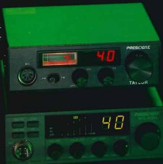
**TAYLOR** - CARATTERISTICHE TECNICHE: 40 canali in AM-FM • Potenza d'uscita: 4 W • Sensibilità: AM 0,5 mV (10 dB S/D), FM 1 mV (20 dB S/D) • CONTROLLI E FUNZIONI: Selettore canali • Volume con interruttore d'alimentazione • Squelch • Indicatore di canale • Visualizzazione a strumento di intensità di campo e di potenza • Controllo automatico per la soppressione dei disturbi • Omologato.
