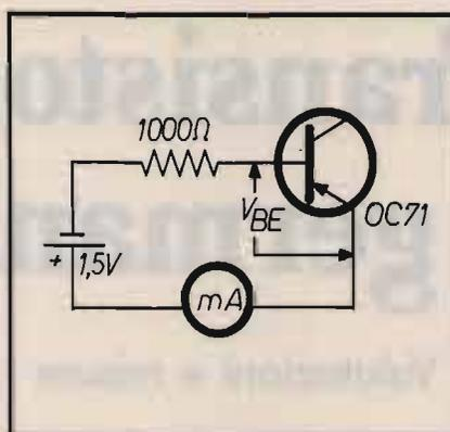
③ La tensione di soglia del GE è 0,1 ÷ 0,2 V, mentre nel silicio è 0,6 ÷ 0,7 V. Ciò permette una facile distinzione fra GE e SI. La  $V_{\text{BE}}$  varia con la corrente e la temperatura.
