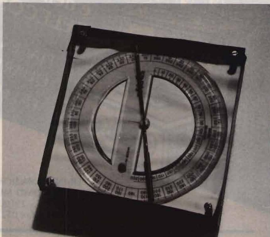
tro a 360 gradi con un diametro minimo di 8 cm e massimo di 12 cm, in caso non si trovi un tale goniometro si può sopperire al caso con 2 da 180°; poi da un falegname ci si procura una tavoletta di legno dolce, pino ad esempio, con dimensioni appropriate al diametro del goniometro. Esempio: goniometro di diametro 10 cm, tavoletta di 11 x 11 cm, lo spessore di tale tavoletta deve essere di circa 2,2/2,5 cm perfettamente squadrata e lisciata, oltre a questa, un'altra di cm 8 x 4 stesso spes-
