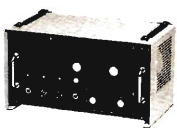
BRL 500 amplificatore lineare Potenza d'ingresso 0.2-10 W AM. Potenza di uscita 500 W AM. Tensione di alimentazione 220 V a.c.
