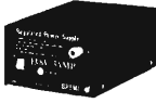
BRS 26 alimentatore stabilizzato 13.8 V c.c. ± 5% - 3 A fissi, 5 A di picco - Stabilità: 4% - Ripple: 15 mV
