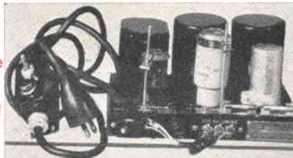
RA133-A Alimentatore originale americano per il BC221
