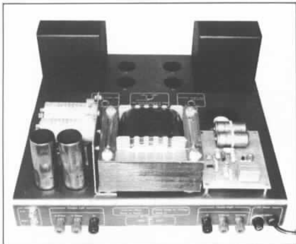
Fig. 17 : En premier plan, le transformateur d'alimentation, au centre l'alimentation régulée, à droite la self de filtrage et les condensateurs de filtrage à gauche.
