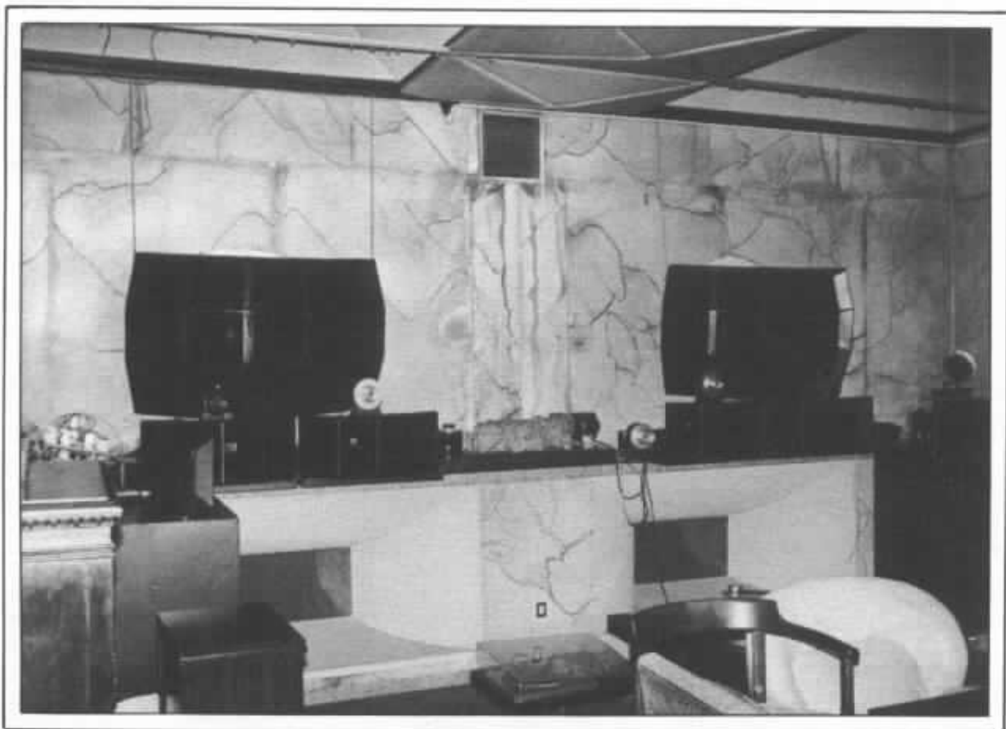
Vue d'ensemble du système de reproduction à cinq voies. Remarquer en plus du système principal l'impressionnante collection de divers appareils électroacoustiques.
