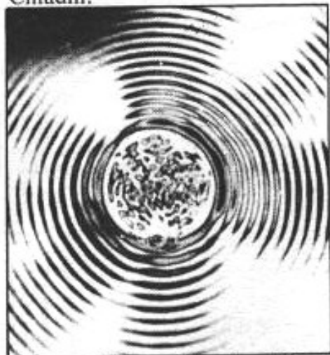
Mise en évidence du « Break-Up » (fonctionnement non contrôlé) de la membrane d'un haut-parleur par procédé holographique (d'après F.J.M. Frankort, H.T.S., Hollande).
