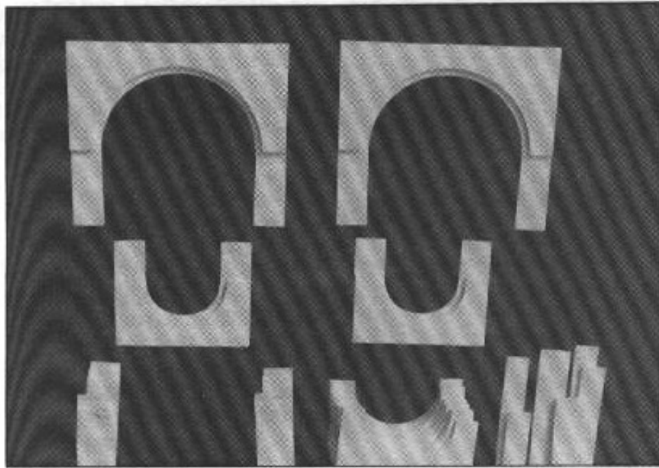
Pièces de plastique de 3 mm d'épaisseur utilisées pour la fabrication des cadres dans lesquels sont collés les électrodes.
