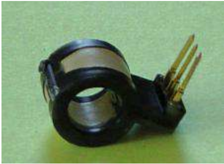
Figura C6.4 Trasduttore di corrente a effetto Hall.
