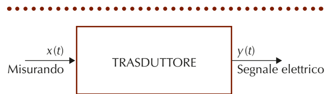
Figura C1.2 Rappresentazione schematica del trasduttore.
