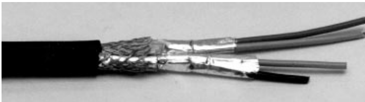
Fig. 3.24 - Cavo "tipo 1" IBM.
